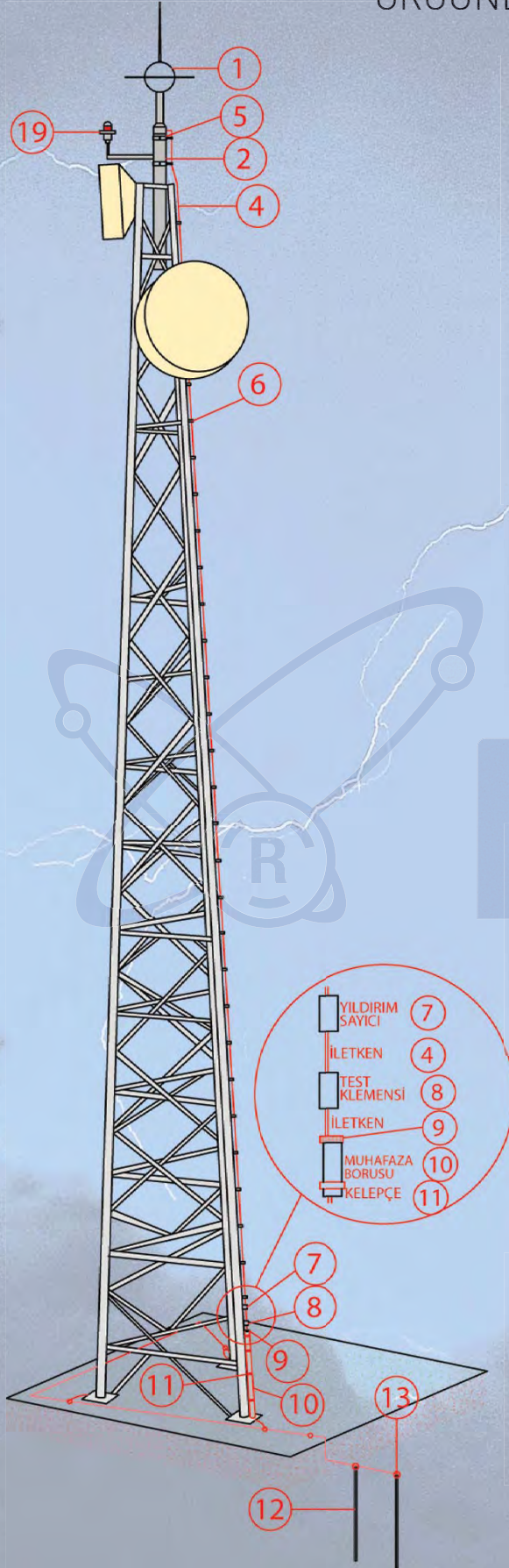
Şekil 11 Kafes Kule'de Paratoner ve Topraklama Uygulama Örneği
