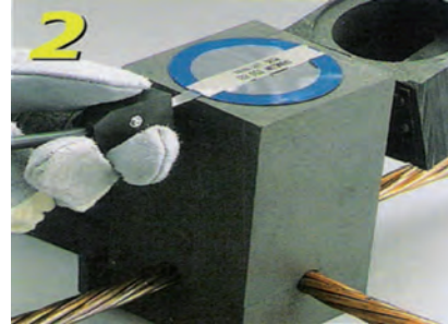
Adım2: Ateşleme şeridine kontrol birimi terminal klipsi tutturulur. Step 2: Attach Control Unit termination clip to ignition strip. Place baffle onto mold.
