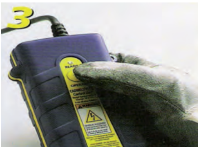
Adım3: Kontrol birimi anahtarına basılır ve tutulur. Ateşleme için beklenir. Step 3: Press and hold Control Unit switch and wait for ignition.
