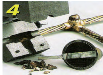
Adım4: Pota açılır ve çelik kap atılmak için kaldırılır. Özel imha gerekmez. Step 4: Open the mold and remove the expended steel cup - no special disposal required.
