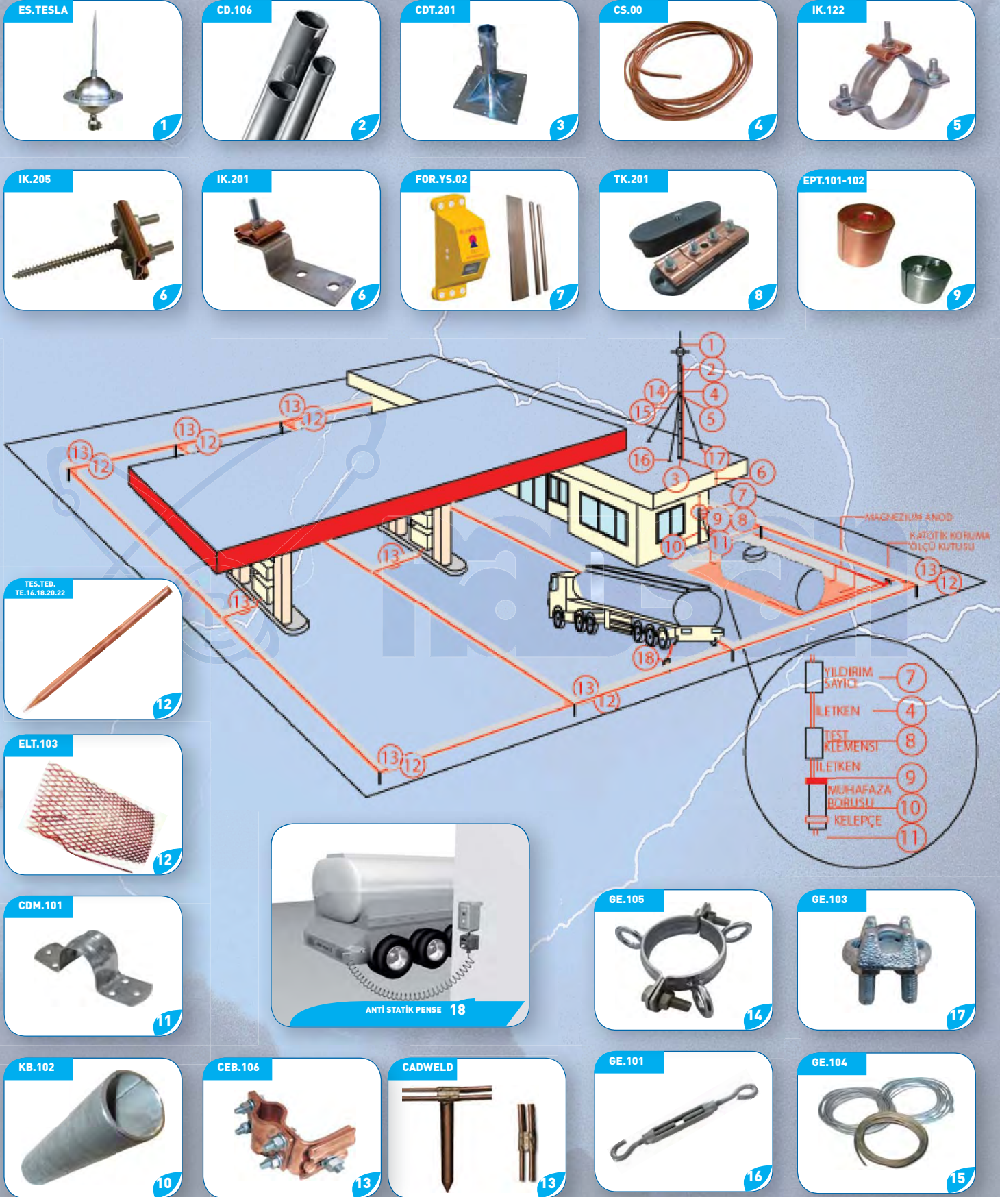
Şekil 10 Akaryakıt İstasyonunda Paratoner ve Topraklama Uygulama Örneği
